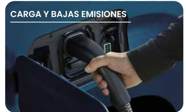
El nuevo Fiat Doblò tiene una batería de 50 kWh y un motor de 100 kW de potencia, los mejores del segmento, capaces de garantizar una autonomía de hasta 320 km en alcance WLTP (ciclo combinado) y una velocidad máxima de 135 km/h con una reducción significativa de las emisiones.
